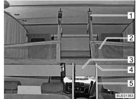
Fig. 128 Cama elevada con red de seguridad tendida
