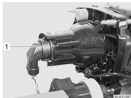
Fig. 263 Luz de cruce/luz larga/luz de estacionamiento
