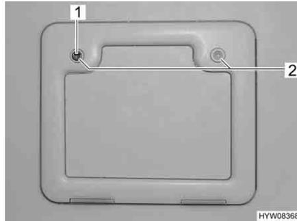
Fig. 251 Trampilla para el depósito de aguas fecales
