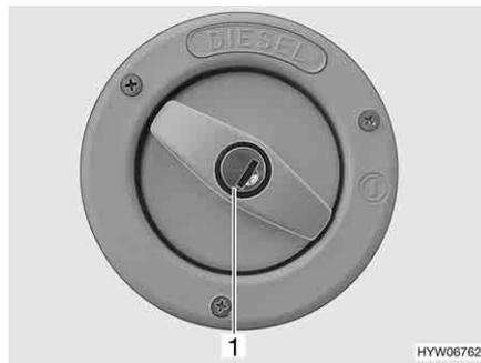
Fig. 46 Tapa de cierre para el tubo de llenado de combustible
