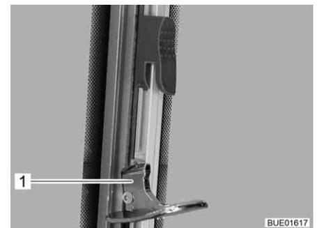
Fig. 104 Ventana corredera con bloqueo giratorio (desbloqueado)
