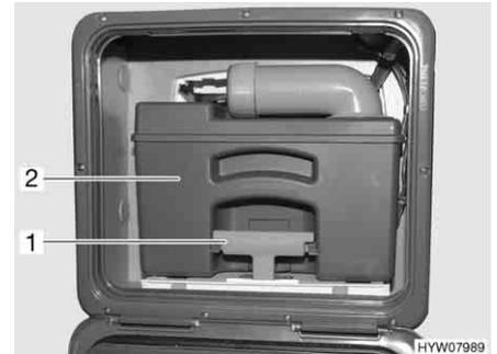
Fig. 252 Depósito de aguas fecales
