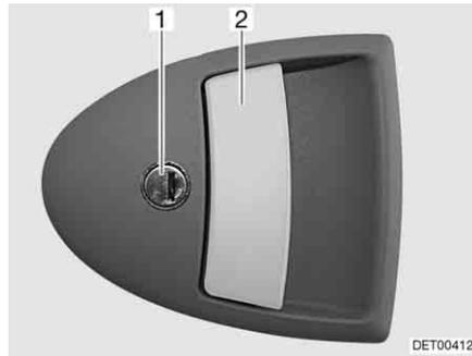
Fig. 59 Cerradura de la puerta de entrada, en el exterior
