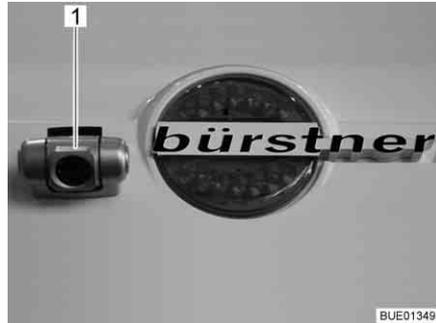
Fig. 17 Cámara de marcha atrás con iluminación infrarroja (Waeco)
