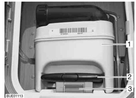
Fig. 240 Depósito de aguas fecales
