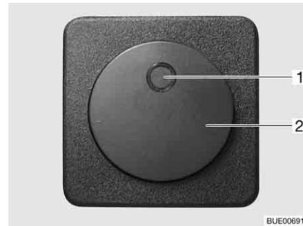
Fig. 196 Interruptor para calentamiento eléctrico del piso
