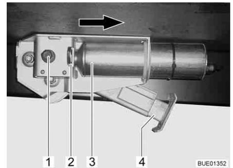
Fig. 51 Apoyo de elevación eléctrico en el vehículo
