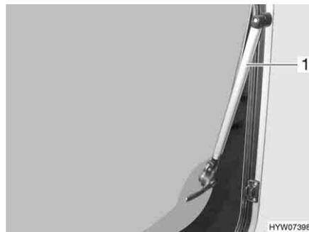
Fig. 99 Ventana abatible con soporte automático
