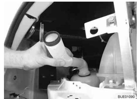
Fig. 45 Tubo de llenado en posición de llenado
