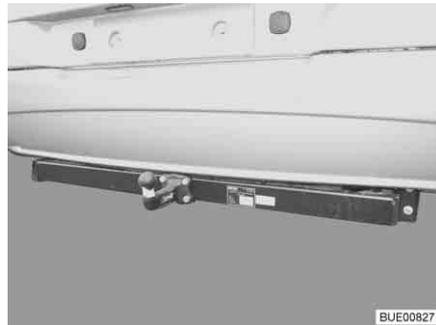
Fig. 9 Acoplamiento de remolque
