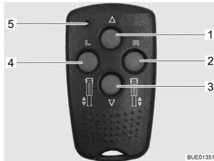
Fig. 49 Mando a distancia para apoyos eléctricos de elevación
