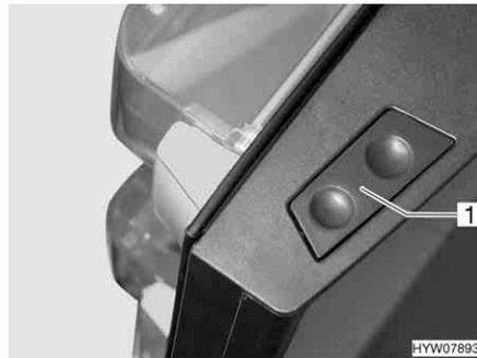
Fig. 219 Botón de desbloqueo de la puerta del frigorífico (Dometic de la serie 8)
