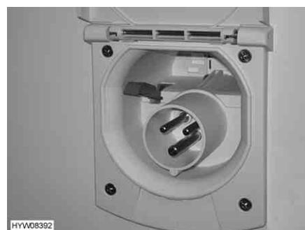
Fig. 161 Conexión de 230 V en el vehículo
