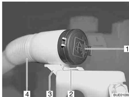
Fig. 44 Tubo de llenado depósito de agua para lavar
