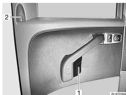
Fig. 56 Cerradura de la puerta del conductor, en el interior
