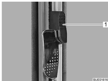
Fig. 103 Ventana corredera con bloqueo giratorio (bloqueado)
