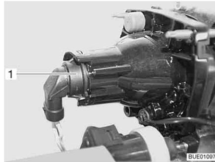
Fig. 259 Luz de cruce/luz larga/luz de estacionamiento
