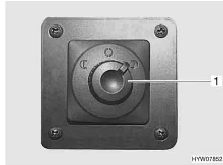
Fig. 33 Interruptor de ajuste de los retrovisores exteriores
