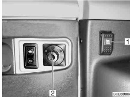
Fig. 32 Interruptor de ajuste de los retrovisores exteriores y de la calefacción de los retrovisores exteriores
