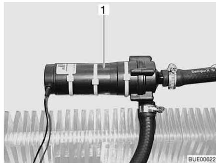
Fig. 192 Bomba de circulación adicional
