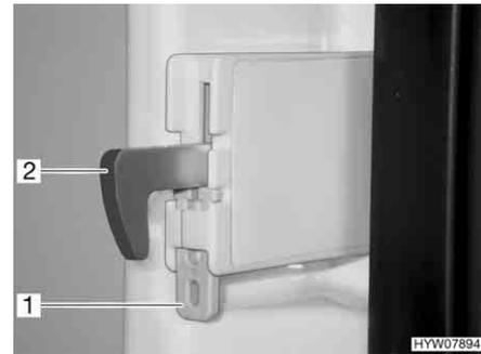
Fig. 220 Fijación del gancho de bloqueo
