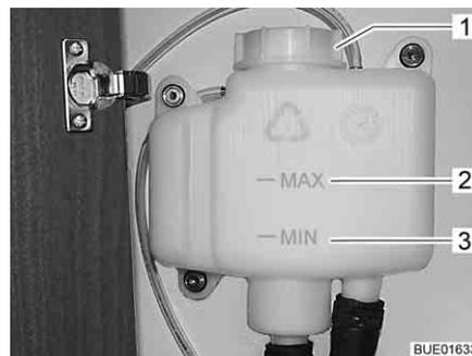
Fig. 255 Recipiente de compensación sin panel
