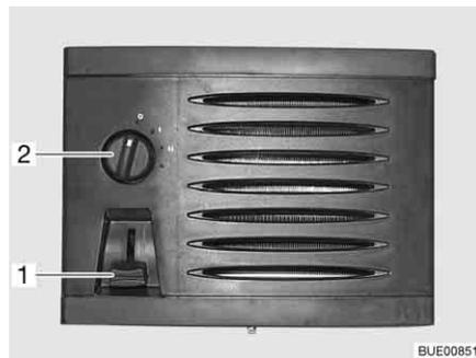
Fig. 194 Elementos de mando termocambiador adicional
