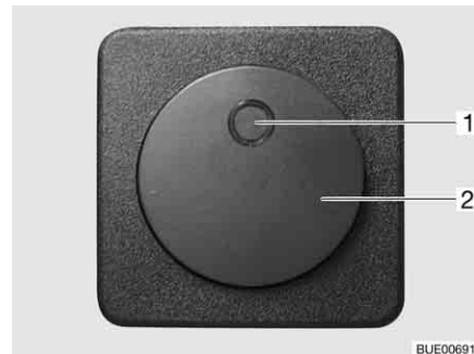
Bild 206 Schalter für elektrische Fußbodenerwärmung
