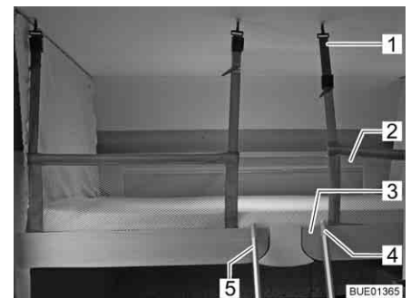
Bild 116 Hubbett mit aufgespanntem Sicherungsnetz
