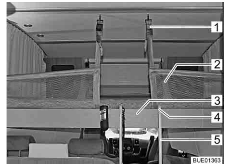
Bild 118 Hubbett mit aufgespanntem Sicherungsnetz
