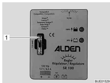
Bild 182 Sicherung Solar-Laderegler 100 W
