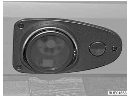
Bild 243 LED-Leuchte mit Schalter
