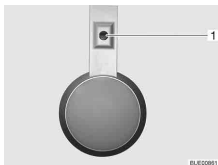
Bild 60 Leuchte, Lichtschalter direkt an der Leuchte
