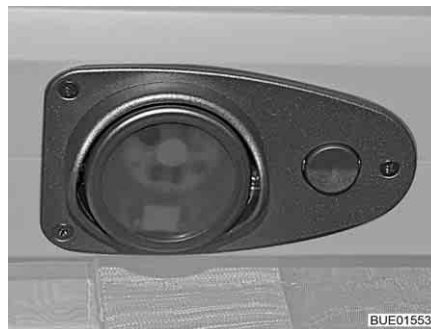
Fig. 243 Lámpara de LED con interruptor
