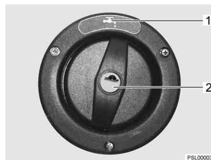
Fig. 52 Tapa de cierre para el tubo de llenado de agua potable
