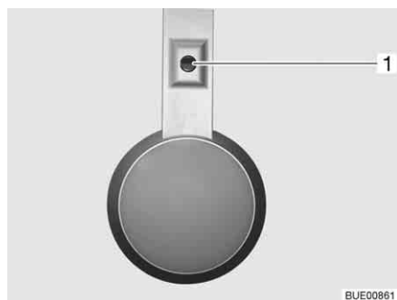
Fig. 60 Lámpara, interruptor de luz directamente en la lámpara
