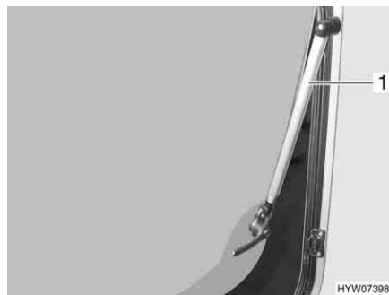
Fig. 80 Ventana abatible con soporte automático
