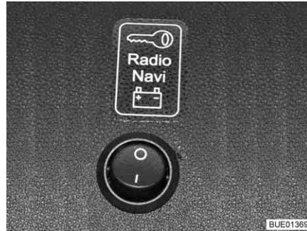
Fig. 129 Conmutador selector para el comportamiento de funcionamiento
