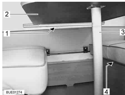
Fig. 104 Mesa colgante con pata de mesa cambiabile
