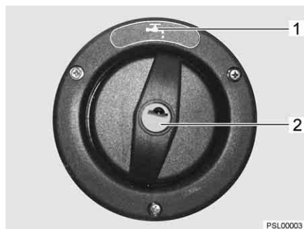
Fig. 195 Tapa de cierre para el tubo de llenado de agua potable
