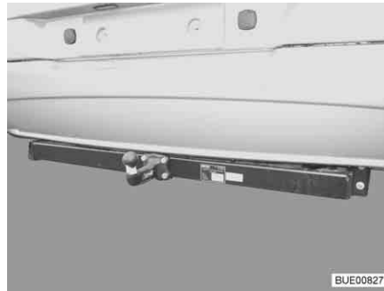
Fig. 10 Acoplamiento de remolque
