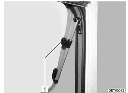
Bild 65 Dachhaube mit Dreh-Ausstellern, geöffnet
