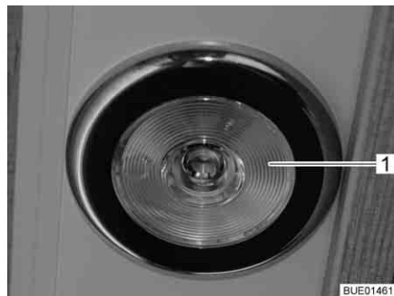
Bild 43 Einbauleuchte, Lichtschalter in der Leuchte
