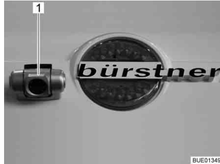
Bild 16 Rückfahrkamera mit Infrarotbeleuchtung (Waeco)
