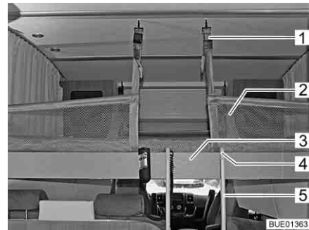
Bild 125 Hubbett mit aufgespanntem Sicherungsnetz
