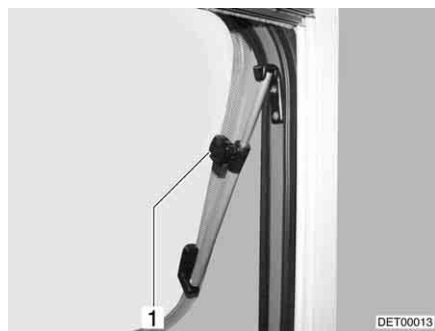
Bild 90 Ausstellfenster mit Dreh-Aussteller
