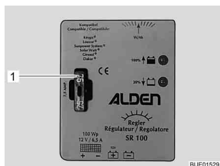
Bild 174 Sicherung Solar-Laderegler 100 W
