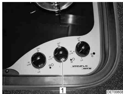
Bild 212 Bedienelemente für Gaskocher
