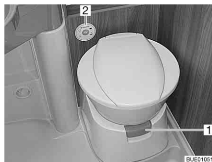
Bild 277 Toilettenschüssel mit Kontroll- und Bedieneinheit
