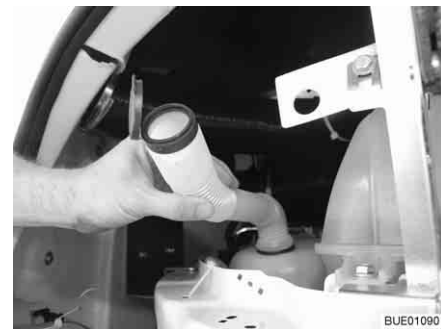
Bild 43 Einfüllstutzen in Füllposition
