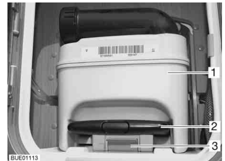
Fig. 282 Réservoir pour matières fécales
