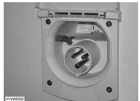
Fig. 179 Raccordement 230 V sur le véhicule
