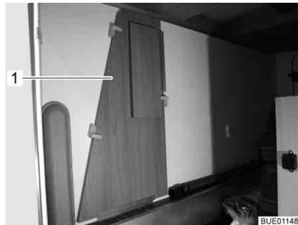
Fig. 17 Rallonge latérale de lit dans le garage arrière
