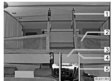
Bild 115 Hubbett mit aufgespanntem Sicherungsnetz
