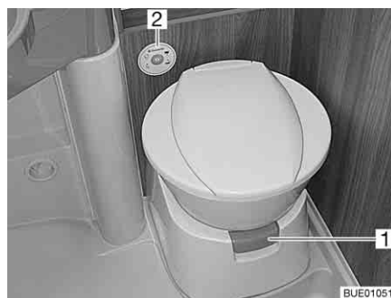
Bild 285 Toilettenschüssel mit Kontroll- und Bedieneinheit
