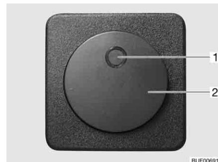
Bild 212 Schalter für elektrische Fußbodenerwärmung
