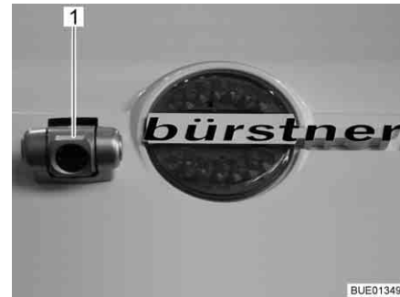
Fig. 22 Câmara de recuo com iluminação de infravermelhos (Waeco)
