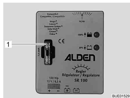
Fig. 187 Fusível do regulador de carga do painel solar 100 W
