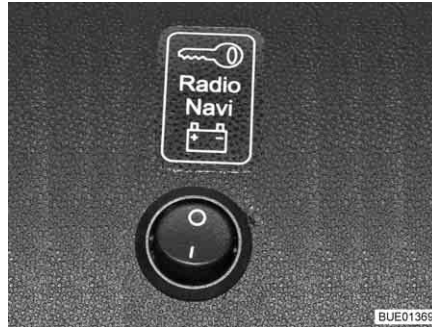
Fig. 169 Interruptor-seletor para o comportamento da bateria
