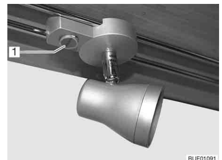
Fig. 58 Projetor, interruptor da luz encontra-se diretamente na luz
