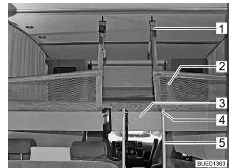
Fig. 115 Cama suspensa com rede de segurança instalada
