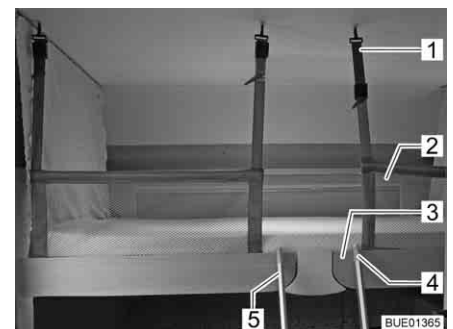
Fig. 113 Cama suspensa com rede de segurança instalada
