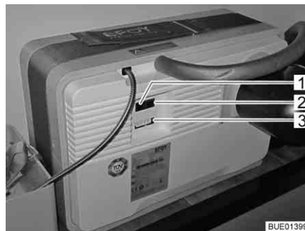
Fig. 174 Área de ligação do gerador 12 V
