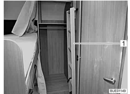
Fig. 18 Escada de acesso no roupeiro
