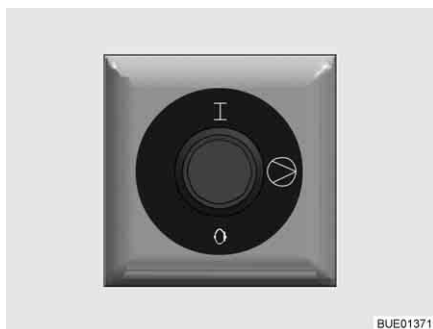
Fig. 209 Interruptor de comando da bomba de recirculação adicional
