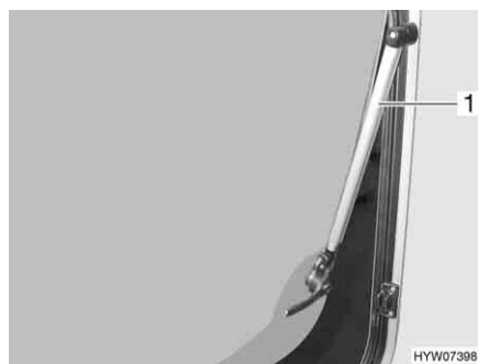
Fig. 75 Janela de projetar com defletor automático
