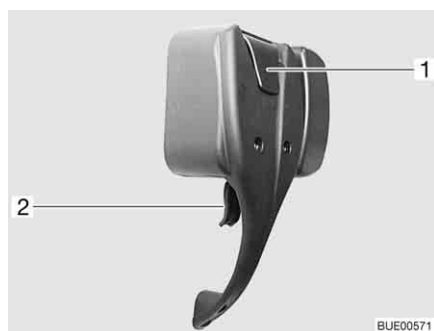
Fig. 42 Fechadura da porta de entrada, lado de dentro, trancada
