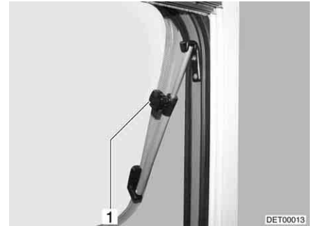
Bild 83 Dachhaube mit Dreh-Ausstellern, geöffnet
