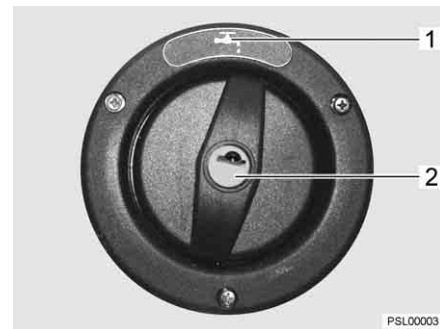
Bild 45 Verschlussdeckel für Trinkwasser-Einfüllstutzen (Alternative)
