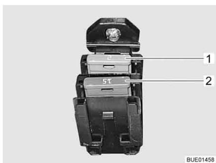
Fig. 129 Fusibles para pila de combustión
