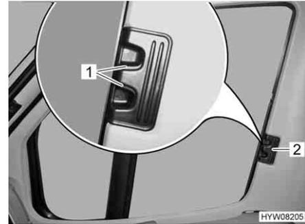
Fig. 26 Estor plegable para la ventana del conductor/acompañante
