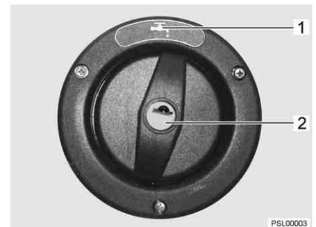
Fig. 45 Tapa de cierre para el tubo de llenado de agua potable (alternativa)
