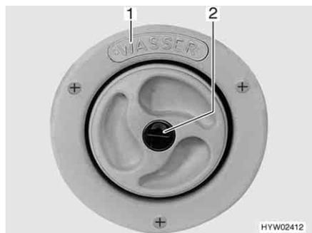
Fig. 177 Tapa de cierre para el tubo de llenado de agua potable
