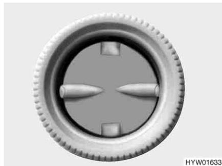
Fig. 141 Boquilla de salida de aire
