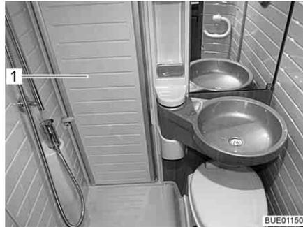
Fig. 17 Panel de separación de la ducha
