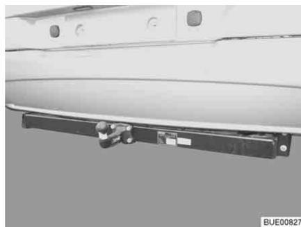
Fig. 8 Acoplamiento de remolque
