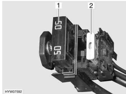
Fig. 127 Fusibles en la batería del habitáculo
