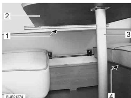
Fig. 90 Mesa colgante con pata de mesa cambiabile
