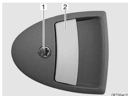
Fig. 36 Cerradura de la puerta de entrada, en el exterior
