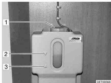
Fig. 219 Recipiente de compensación para la calefacción de agua caliente
