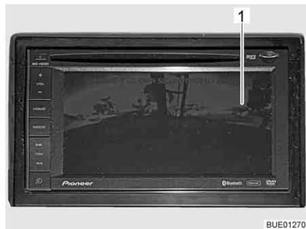
Fig. 21 Monitor LCD para la cámara de marcha atrás (ejemplo)
