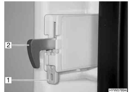
Fig. 174 Fijación del gancho de bloqueo
