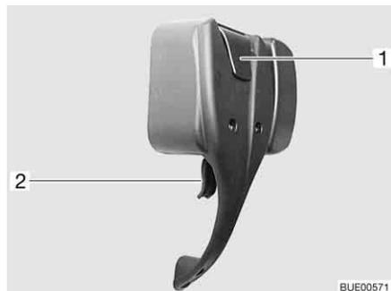
Fig. 35 Cerradura de la puerta de entrada, en el interior, bloqueada
