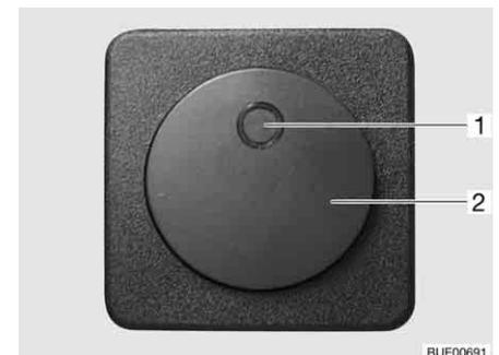
Fig. 153 Interruptor para calentamiento eléctrico del piso
