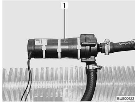
Fig. 148 Bomba de circulación adicional
