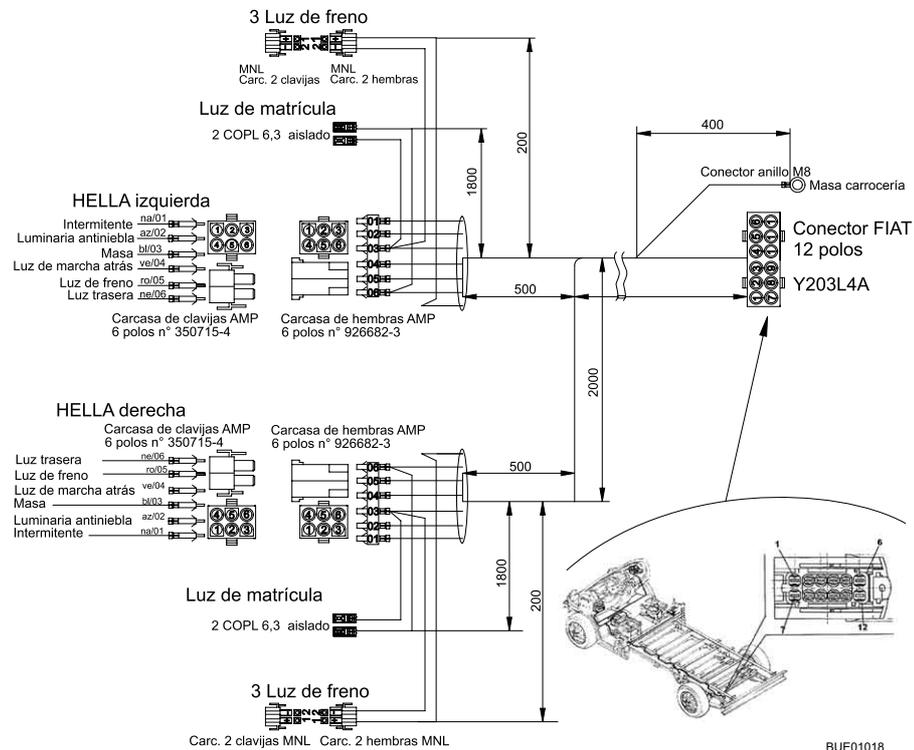
Fig. 139 Esquema de circuitos exterior
