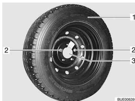
Fig. 240 Soporte para rueda de repuesto en el garaje trasero
