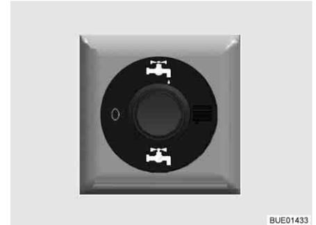
Fig. 206 Interruttore di comando per rubinetto di scarico ad azionamento elettrico (accessorio opzionale)
