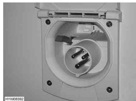
Fig. 137 Collegamento a 230 V sul veicolo
