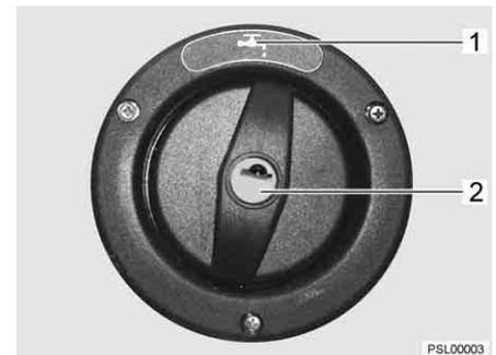
Fig. 200 Coperchio per bocchettone di riempimento dell'acqua potabile (alternativa)
