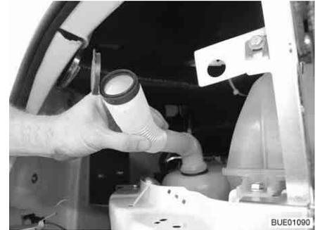
Fig. 32 Bocchettone di riempimento in posizione di riempimento
