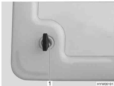
Fig. 51 Serratura a pressione sportello di servizio
