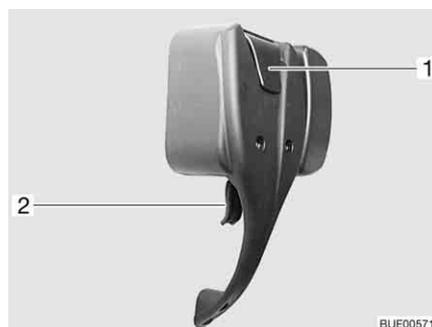
Fig. 44 Serratura della porta di ingresso, lato interno, bloccata
