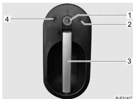
Fig. 41 Serratura della porta conducente, lato esterno
