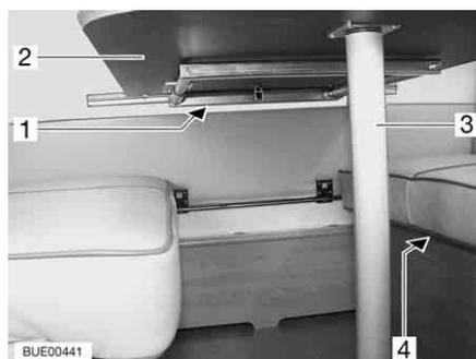
Fig. 95 Trasformazione in struttura di supporto letto
