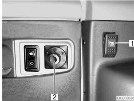
Fig. 25 Interruttore regolazione degli specchietti esterni e riscaldamento degli specchietti esterni
