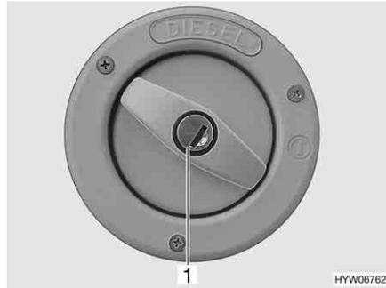
Fig. 33 Coperchio per bocchettone di riempimento per il rifornimento di carburante
