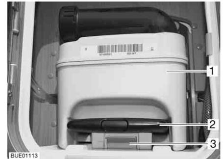
Fig. 243 Serbatoio fecale
