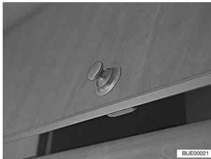
Fig. 55 Sportello del mobile con bottone automatico
