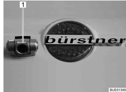
Fig. 15 Telecamera retromarcia con luce a infrarossi
