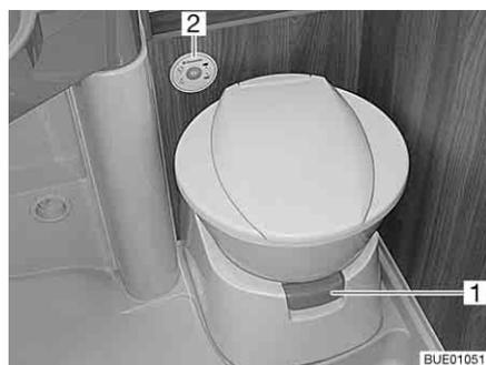
Fig. 246 Tazza del WC con centralina di controllo e di comando
