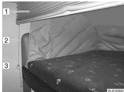
Fig. 104 Tendina oscurante pieghevole, letto basculante
