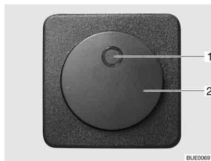
Fig. 169 Interruttore per riscaldamento elettrico del pavimento
