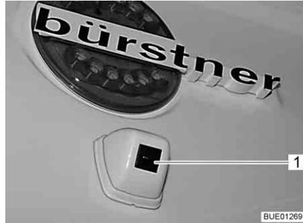
Bild 14 Rückfahrkamera (Beispiel)
