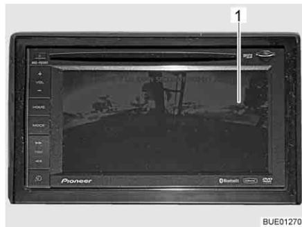
Bild 16 LCD-Monitor für Rückfahrkamera (Beispiel)
