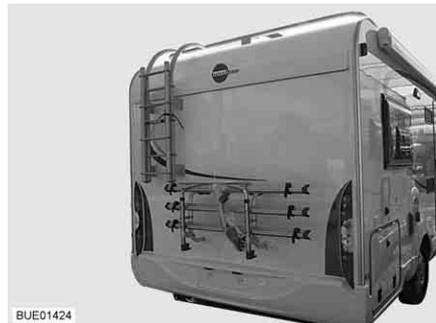
Bild 2 Fahrradträger, maximal 3 Fahrräder
