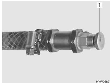
Bild 251 Entlüftungsventil Warmwasser-Heizung
