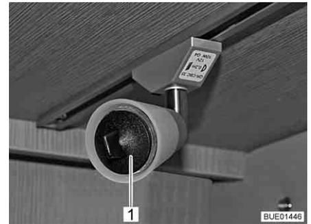
Bild 271 Saugnapf für Lampenwechsel
