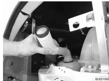
Bild 32 Einfüllstutzen in Füllposition
