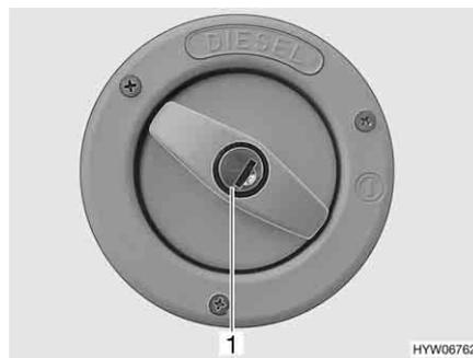
Bild 33 Verschlussdeckel für Kraftstoff-Einfüllstutzen
