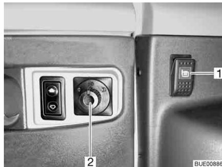
Bild 25 Schalter Außenspiegeleinstellung und Außenspiegelheizung
