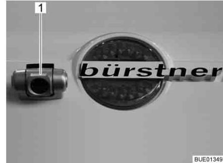
Bild 15 Rückfahrkamera mit Infrarot-Beleuchtung
