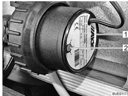
Bild 161 Drehzahlreduzierung
