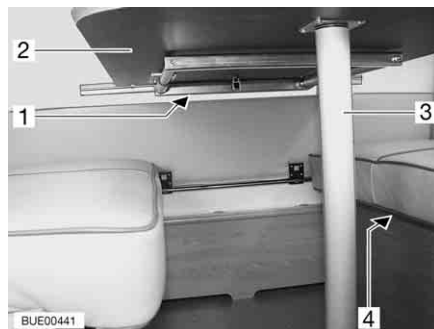
Fig. 89 Transformación en cama
