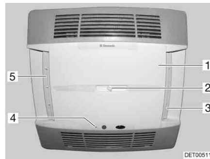
Fig. 201 Instalación de aire acondicionado (Dometic)
