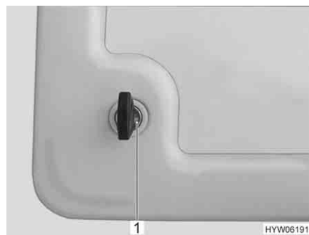
Fig. 42 Cierre a presión de la trampilla de servicio
