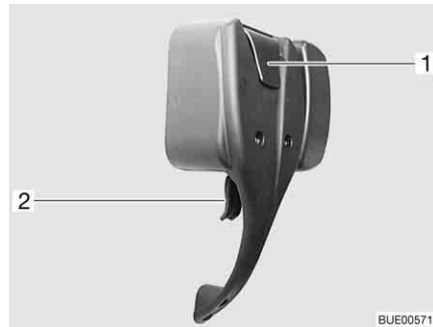
Fig. 36 Cerradura de la puerta de entrada, en el interior, bloqueada
