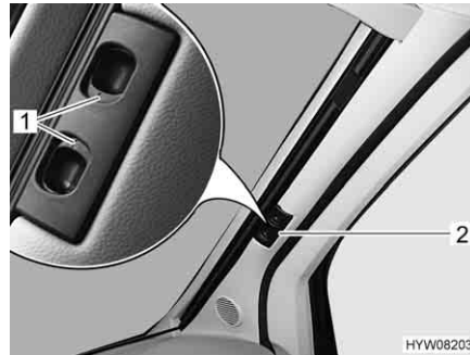
Fig. 74 Estor plegable para la luna delantera
