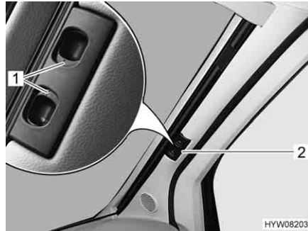
Fig. 26 Estor plegable para la luna delantera
