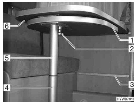
Fig. 85 Mesa colgante con pie de apoyo divisible
