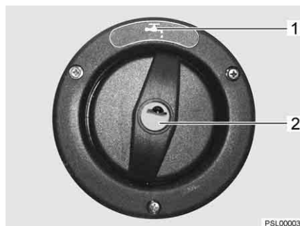
Fig. 45 Tapa de cierre para el tubo de llenado de agua potable (alternativa)
