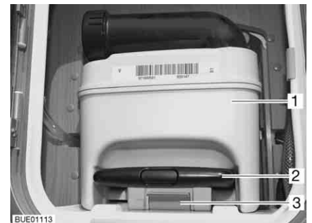
Fig. 270 Depósito de aguas fecales
