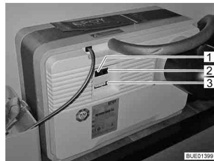
Fig. 164 Campo de conexiones de la pila de combustión
