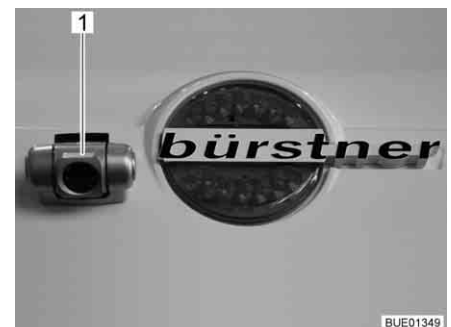
Billede 21 Bakkamera med infrarødt lys
