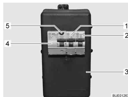
Bild 146 230 V-säkringslåda med ledningsskyddsbrytare och FI-brytare
