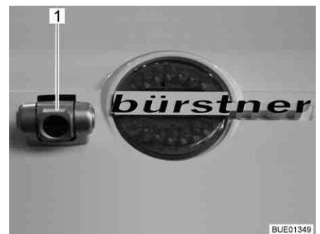
Bild 15 Backningskamera med infraröd belysning
