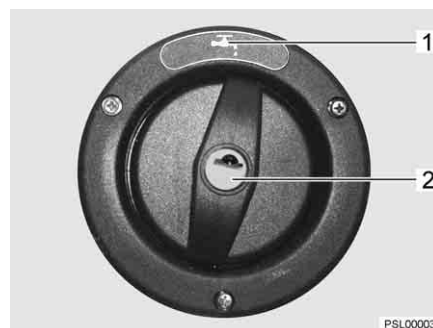
Bild 169 Lock för påfyllningsöppningen för dricksvatten (alternative)
