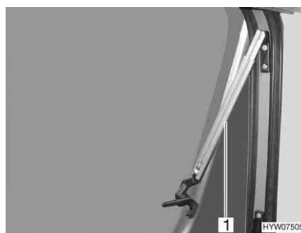
Bild 60 Överkantshängt fönster med automatik-spärrar, öppet
