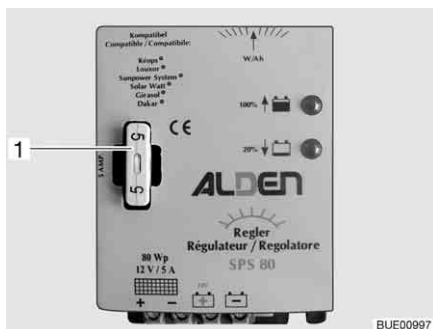
Bild 120 Säkring till laddningsregulator för solpanel
