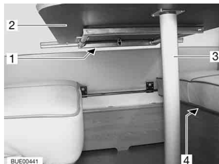
Bild 76 Ombyggnad till säng
