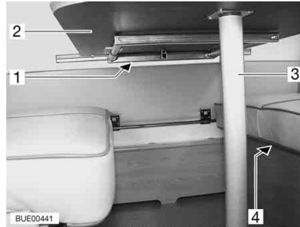
Fig. 76 Trasformazione in struttura di supporto letto
