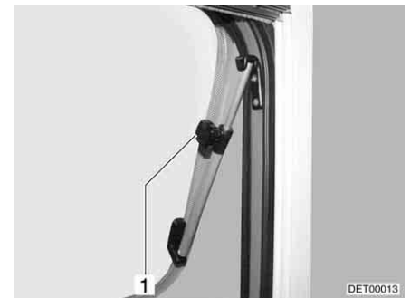
Kuva 57 Avattavat ikkunat, joissa on kääntöpidikkeet, avattu
