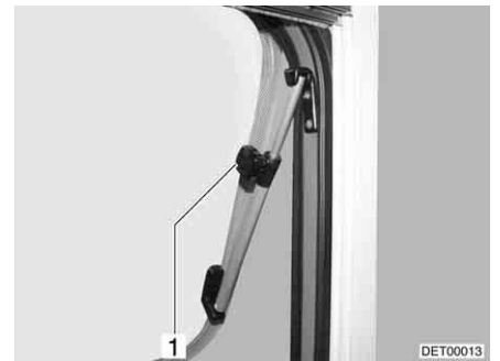
Kuva 71 Kattoluukku, jossa on kääntöpidikkeet, avattu
