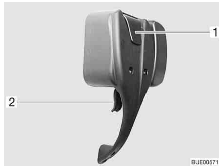
Kuva 28 Sisäänkäyntioven lukko, sisällä, lukittu
