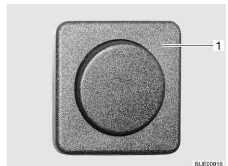
Afb. 58 Toiletruimteverlichting, lichtschakelaar gescheiden van de lamp
