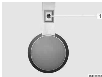
Afb. 57 Toiletruimteverlichting, lichtschakelaar direct bij de lamp
