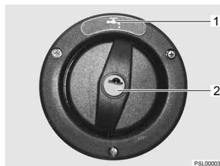
Bild 39 Lock för påfyllningsöppningen för dricksvatten (alternativ)
