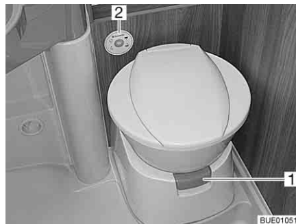
Bild 262 Toalettskål med kontrollenhet
