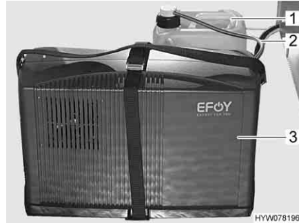
Bild 153 Bränslecell med tankpatron
