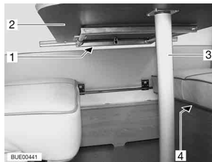
Fig. 80 Trasformazione in struttura di supporto letto
