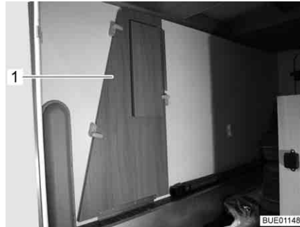
Fig. 12 Allargamento letto nel garage di coda
