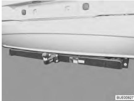
Fig. 6 Dispositif d'attelage
