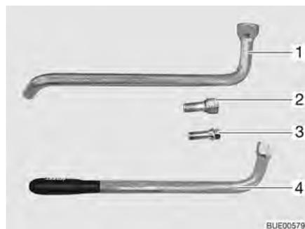
Fig. 262 Boulons de roue avec outils de bord
