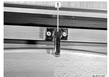
Fig. 105 Dispositif de verrouillage
