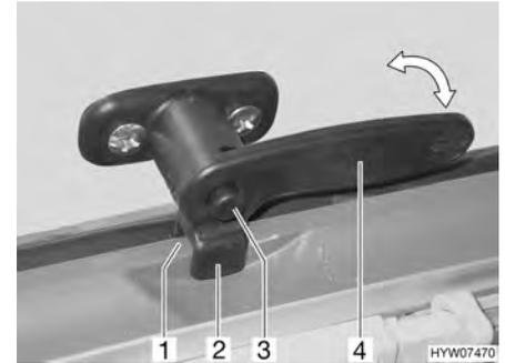
Fig. 62 Levier de verrouillage avec bouton de sécurité en position "Aération permanente"
