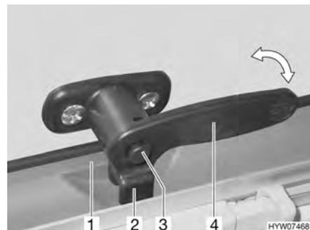
Fig. 60 Levier de verrouillage avec bouton de sécurité en position "Fermé"
