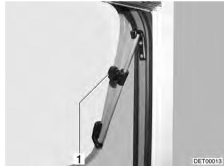
Fig. 55 Fenêtre projetante avec bras pivotants, ouverte
