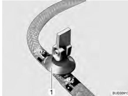
Fig. 208 Robinet de vidange (avec levier à bascule)
