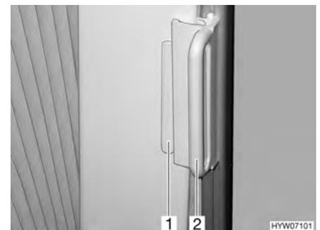
Fig. 72 Dispositif occultant plissé pour les fenêtres côté conducteur et passager
