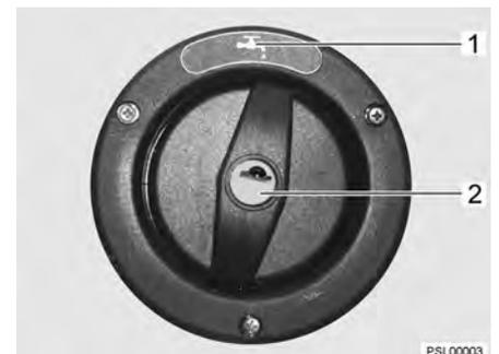
Fig. 40 Couvercle de fermeture pour bec de remplissage d'eau potable (alternative)
