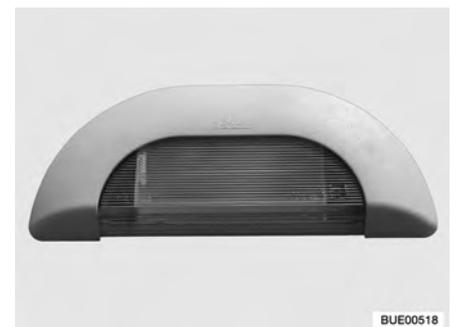
Fig. 45 Eclairage de l'auvent (partiellement équipement spécial)
