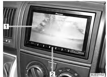
Fig. 18 Moniteur ACL pour caméra de marche arrière
