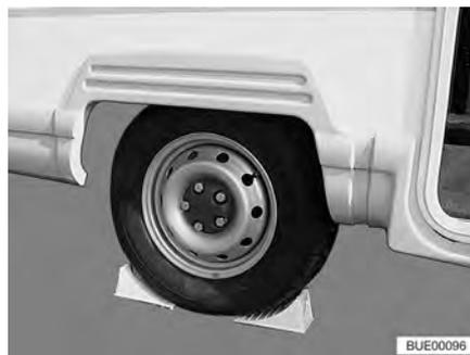
Fig. 263 Bloquer le véhicule
