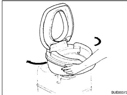
Fig. 216 Tourner la cuvette des WC
