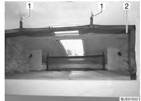
Fig. 101 Lit escamotable avec filet de sécurité tendu
