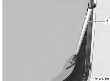
Fig. 64 Fenêtre projetante avec bras automatiques
