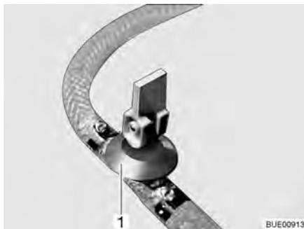
Fig. 206 Robinet de vidange (avec levier à bascule)
