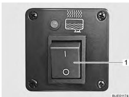
Fig. 205 Commutateur de commande
