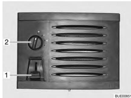
Fig. 165 Boutons de commande d'échangeur de chaleur supplémentaire
