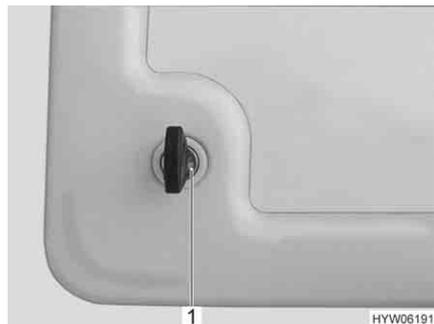
Bild 37 Druckschloss Serviceklappe
