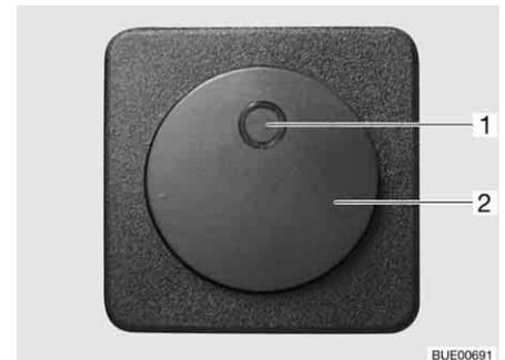
Bild 167 Schalter für elektrische Fußbodenerwärmung
