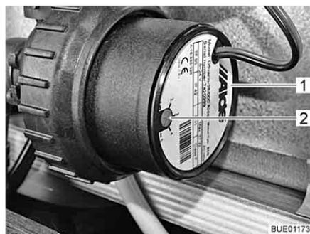
Bild 160 Drehzahlreduzierung
