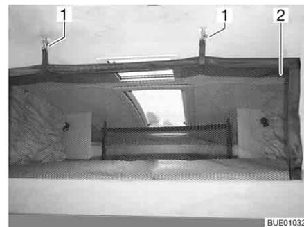
Bild 99 Hubbett mit aufgespanntem Sicherungsnetz
