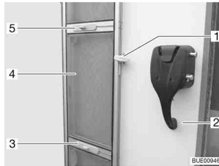
Bild 32 Insektenschutztür, eingeklappt
