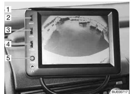
Bild 18 LCD-Monitor für Rückfahrkamera
