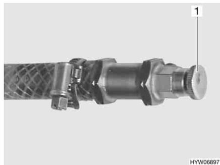
Bild 248 Entlüftungsventil Warmwasser-Heizung
