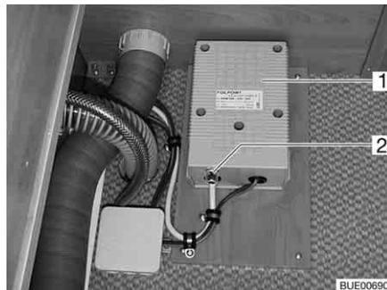
Bild 166 Trafo für elektrische Fußbodenerwärmung
