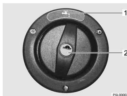
Bild 202 Verschlussdeckel für Trinkwasser-Einfüllstutzen (Alternative)
