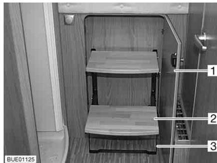
Bild 104 Trittstufe, ausgeklappt
