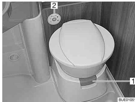
Bild 243 Toilettenschüssel mit Kontroll- und Bedieneinheit
