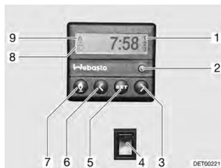
Bild 140 Kontrollenhet för motorvärme
