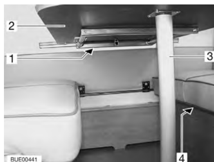
Bild 75 Ombyggnad till säng
