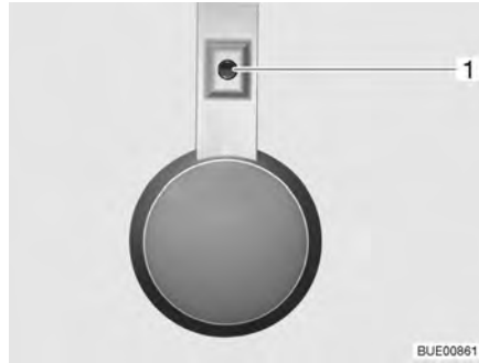
Bild 44 Toalettbelysning, ljusbrytare direkt på lampan
