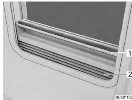
Fig. 40 Dispositif occultant plissé
