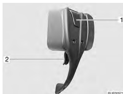
Fig. 37 Serrure de la porte cellule, à l'intérieur, verrouillée
