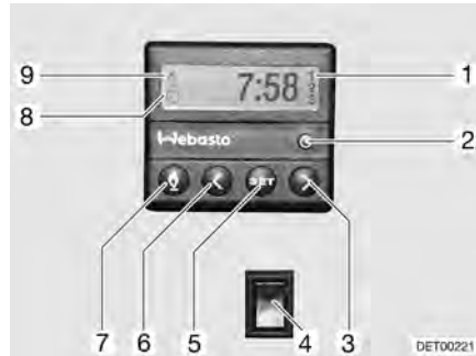
Bild 146 Kontrollenhet för motorvärme
