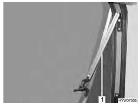
Afb. 67 Uitzetbaar raam met automatische uitzetters
