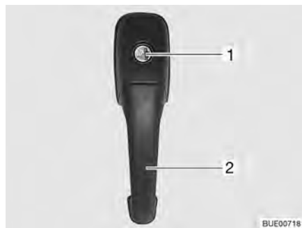
Afb. 36 Deurslot ingangsdeur, buiten
