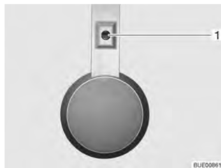
Afb. 52 Toiletruimteverlichting, lichtschakelaar direct bij de lamp
