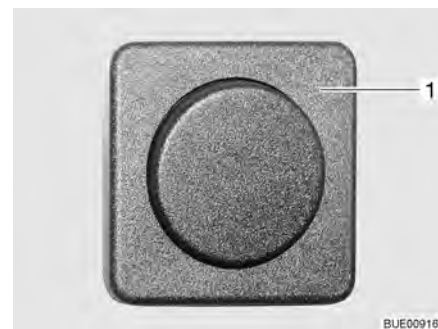
Afb. 53 Toiletruimteverlichting, lichtschakelaar gescheiden van de lamp
