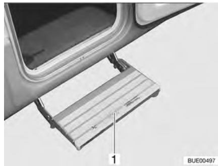
Fig. 8 Escalón de entrada
