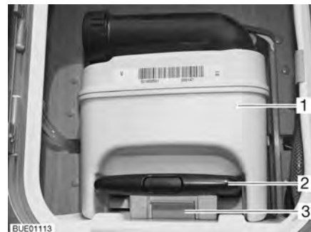
Fig. 240 Depósito de aguas fecales
