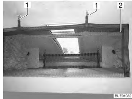
Fig. 101 Cama elevada con red de seguridad tendida
