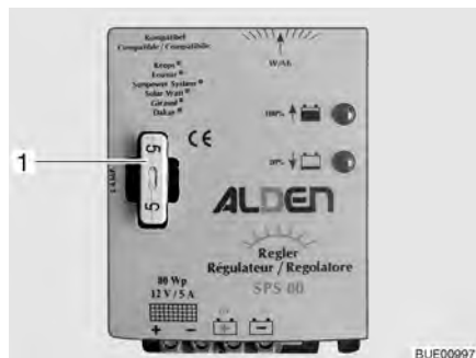
Fig. 144 Fusible del regulador de carga solar
