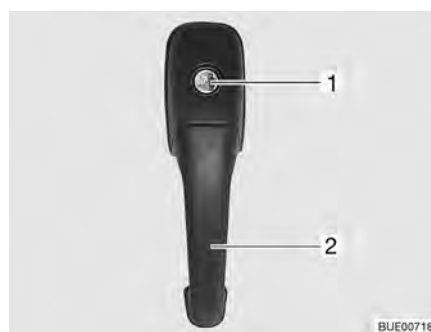
Fig. 27 Cerradura de la puerta de entrada, en el exterior
