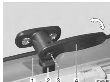
Fig. 60 La palanca de bloqueo con botón de seguridad en la posición "cerrada"
