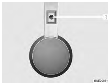
Fig. 46 Illuminazione del vano WC, interruttori luci in corrispondenza della lampada
