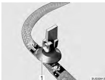
Fig. 208 Rubinetto di scarico (con leva a bilancere)
