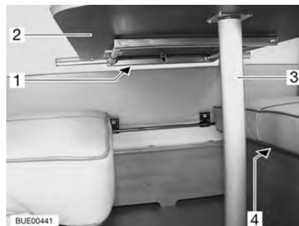
Fig. 86 Trasformazione in struttura di supporto letto
