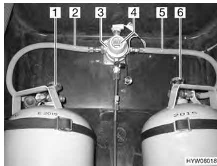
Fig. 129 Impianto di commutazione DuoControl
