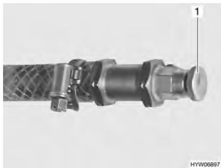
Fig. 248 Valvola di sfiato del riscaldamento ad acqua calda
