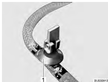
Fig. 206 Rubinetto di scarico (con leva a bilancere)
