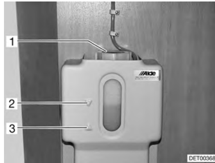
Fig. 247 Vaso d'espansione del riscaldamento ad acqua calda
