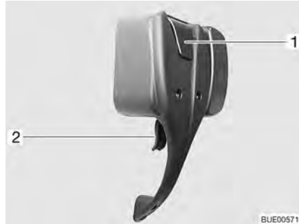
Fig. 28 Serratura della porta di ingresso, lato interno, bloccata
