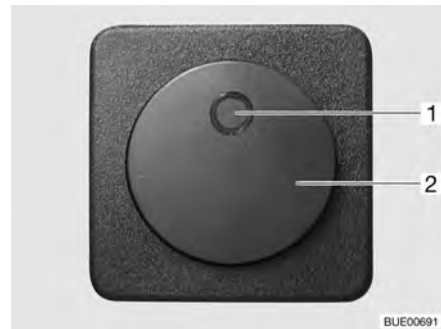
Fig. 167 Interruttore per riscaldamento elettrico del pavimento
