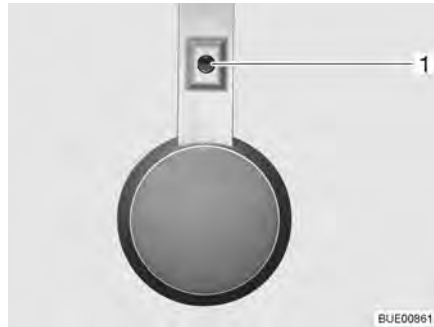
Afb. 46 Toiletruimteverlichting, lichtschakelaar direct bij de lamp
