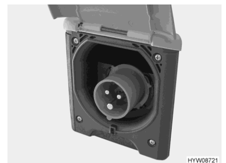
Afb. 48 230-V-aansluiting op het voertuig (CEE-contactdoos)
