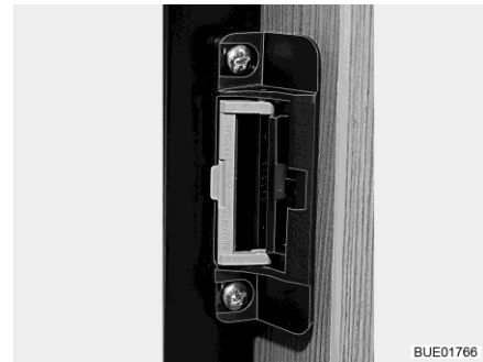
Fig. 90 Dispositivo di chiusura in posizione di ricircolo d'aria
