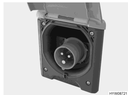
Fig. 72 Collegamento a 230 V al veicolo (presa CEE)
