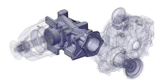
■ Ensemble mécanique transmettant le couple moteur au pont arrière par l'intermédiaire d'un renvoi d'angle.
