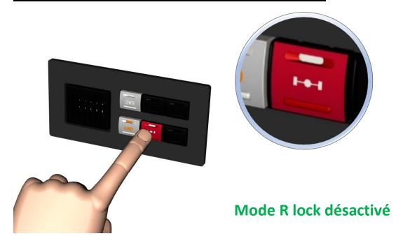
Pour passer en mode 4WD normal, Appuyer sur l'interrupteur marron, à gauche du poste de conduite. Le voyant de couleur orange sur le bouton R Lock va s'éteindre et le signal intermittent lent s'arrêter.
