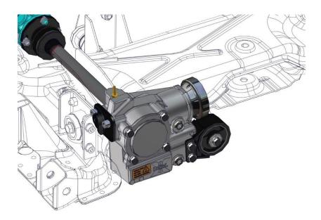
• Ensemble mécanique transmettant le couple moteur à la transmission longitudinale par l'intermédiaire d'un renvoi d'angle.
