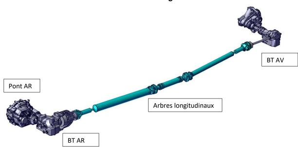
Elément mécanique transmettant le couple moteur aux roues arrière par l'intermédiaire d'un coupleur.
