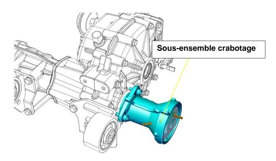
■ Ensemble mécanique permettant le passage de 2 à 4 roues motrices et inversement grâce à la commande présente sur la planche de bord.
