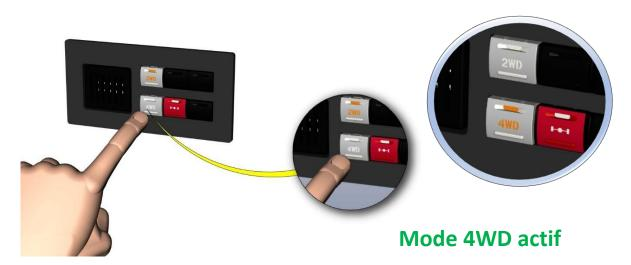
Appuyer sur le bouton de commande 4WD, l'activation du mode 4x4 se matérialise par l'allumage d'un voyant de couleur orange sur le bouton 4WD.
