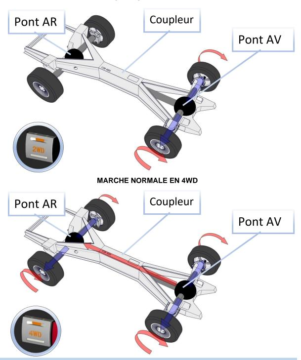
Le fonctionnement du système 4 roues motrices conçu et réalisé par Automobiles DANGEL repose sur une distribution automatique et optimale du couple moteur dont le coupleur est le cœur du système.
