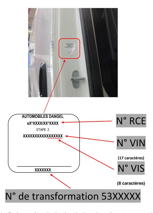
Cette identification est nécessaire dans le cadre du service après-vente ou encore de la garantie.
