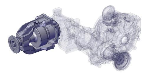
Actif en permanence, il décèle la perte d'adhérence des roues avant et transmet alors aux roues arrière le couple moteur. Le coupleur va ajuster le pourcentage du couple en fonction du besoin.
