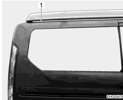
Fig. 25 Riel para refuerzo del borde de un toldo parasol o de un toldo de bolsa
