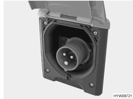
Fig. 33 Conexión de 230 V en el vehículo (caja de enchufe CEE)
