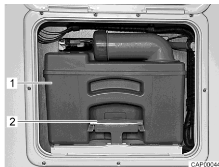
Fig. 108 Depósito de aguas fecales
