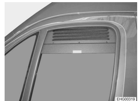
Fig. 54 Rejilla de ventilación forzada (ventana lateral cerrada)
