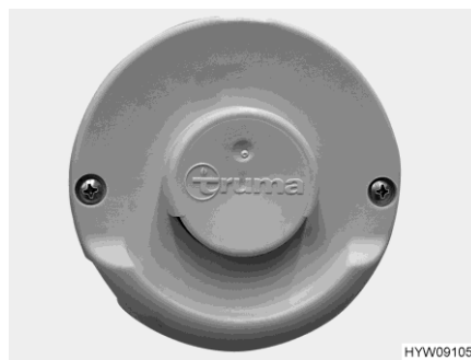
Fig. 85 Tubo de chimenea en la pared (calefacción de aire caliente)
