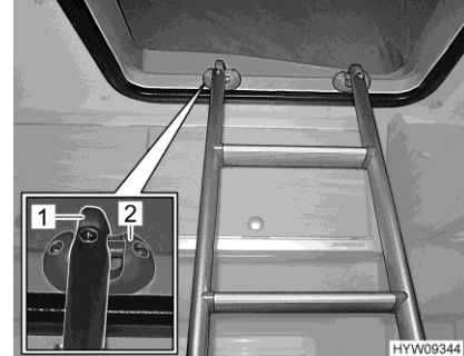
Fig. 58 Escalera de ascenso (enganchada)
