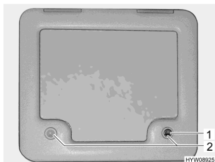
Fig. 107 Trampilla para el depósito de aguas fecales
