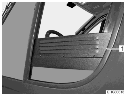
Fig. 53 Rejilla de ventilación forzada (ventana lateral abierta)
