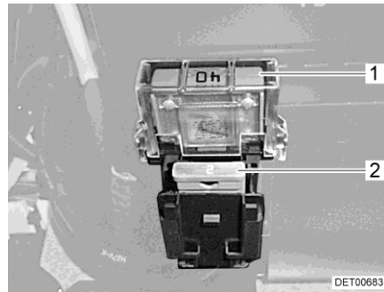
Bild 76 Säkringar vid bodelsbatteriet
