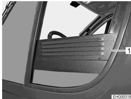
Bild 53 Ventilationsgaller (sidofönster öppet)
