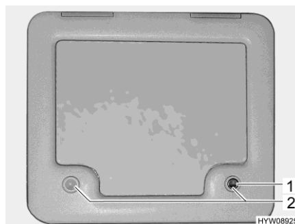
Bild 107 Lucka för latrintanken
