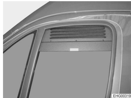
Bild 54 Ventilationsgaller (sidofönster stängt)
