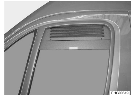
Afb. 54 Rooster voor kunstmatige ventilatie (zijraam gesloten)
