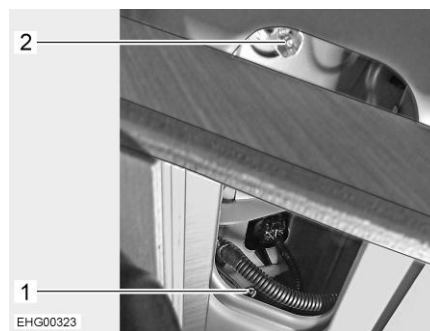
Afb. 110 Bevestiging van de achterlichteenheid
