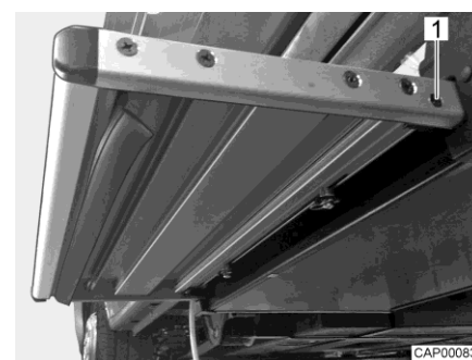
Fig. 100 End stop (entrance step)
