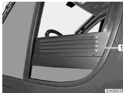
Afb. 46 Rooster voor kunstmatige ventilatie (zijraam geopend)
