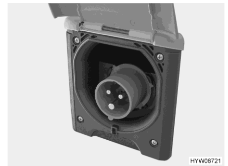
Afb. 65 230-V-aansluiting op het voertuig (CEE-contactdoos)
