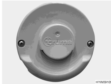
Afb. 77 Wandschoorsteen (hete- luchtverwarming)
