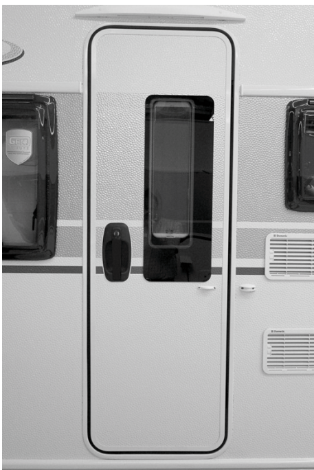
Fig. 17: Porta di ingresso con finestra (esempio)
