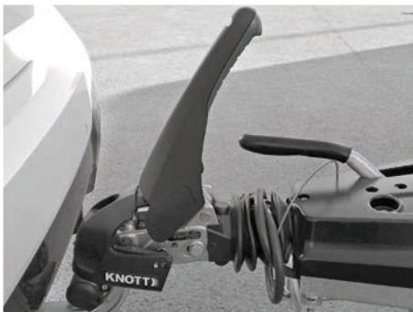
Fig. 9: Attacco sferico chiuso, stabilizzazione disattivata
