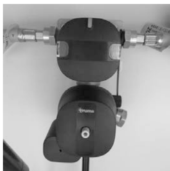
Fig. 79: Alimentazione del gas (con resistenza “Eis-Ex” e indicatore a distanza)
