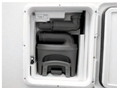
Fig. 53: Serbatoio acque nere con bocchettone di riempimento dell'acqua di risciacquo
