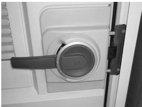
Fig. 20: Serratura della porta chiusa, ma non bloccata
