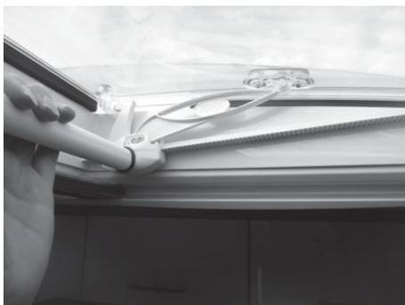
Abb. 127: Dachhaube 400x400 mm bedienen
