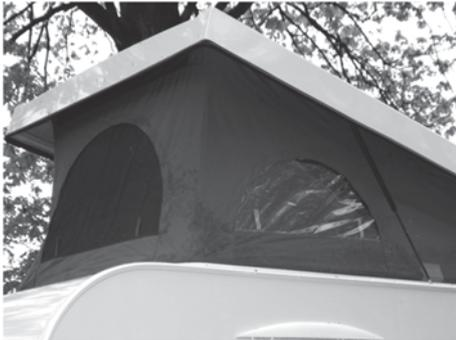
Abb. 30: Aufstelldach, aufgestellt
