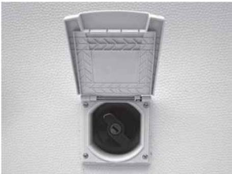
Abb. 92: Frischwasser-Einfüllstutzen
