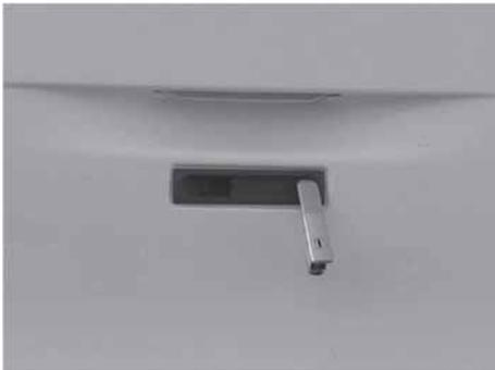
Abb. 73: Gasflaschenkastenschloss entriegelt
