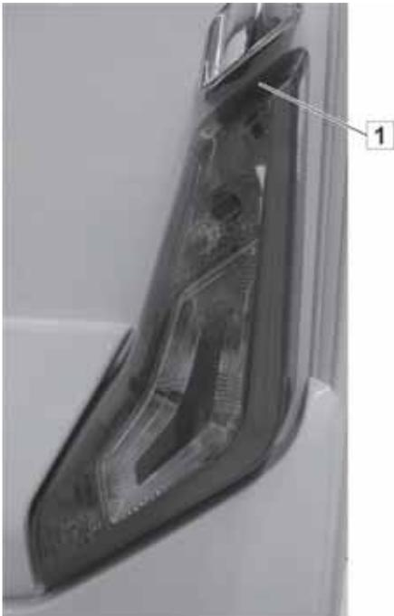
Abb. 226: Hybrid-Leuchte lösen
