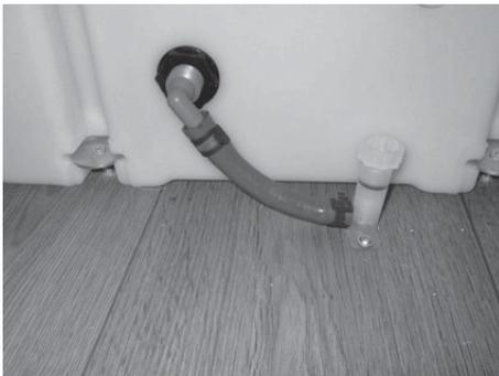
Das zweite Entleerungsventil ist seitlich am Tank angebracht und über eine Rändelschraube bedienbar. Es dient zur einfachen Regulierung des Frischwasser-Füllstands. Durch Öffnen des zweiten Entleerungsventils verringert sich das Füllvolumen des Frischwassertanks. Durch diesen Vorgang kann die Zuladung des Caravans erhöht werden.
