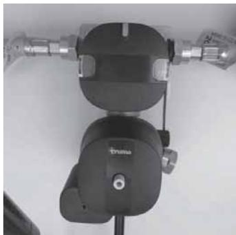
Abb. 76: Gasversorgung (mit Eis-Ex und Fernanzeige)
