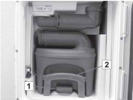
Abb. 200: Fäkalientank im Entsorgungsschacht
