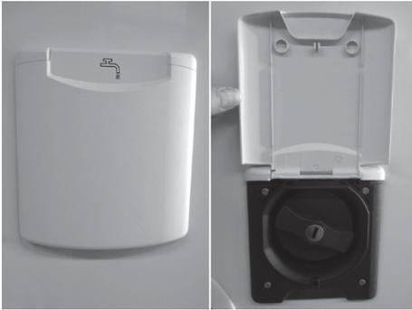
Abb. 104: Frischwasser-Einfüllstutzen
