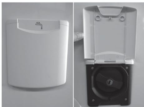
Abb. 21: Frischwassereinfüllstutzen
