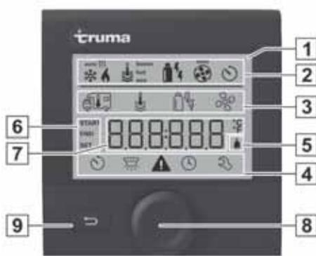
Abb. 140: Digitale TRUMA-Bedieneinheit CP Plus
