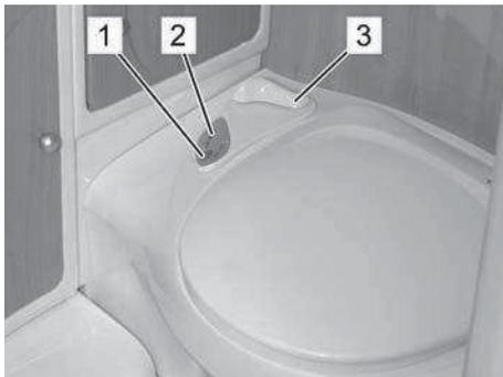
1. Vor dem Spülen den Schieber des Fäkalientanks öffnen. Dazu Hebel (3) nach vorn ziehen.
