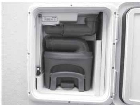
Abb. 46: Fäkalientank mit Spülwasser-Einfüllstutzen
