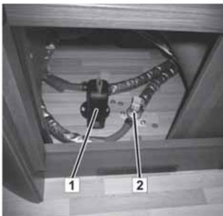
Abb. 108: Ablassventile TRUMA-Combi-Heizung
