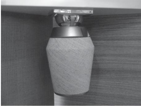
Im Innenbereich befindet sich über der Sitzgruppe und im Schlafbereich ein Beleuchtungs-Schienensystem mit dreh-, schwenk- und versetzbaren 12-V-LED-Strahlern, die für eine gute Ausleuchtung der Plätze sorgen (Handhabung → Abschnitt "Beleuchtung einrichten").
