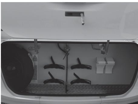
Abb. 74: Gasflaschenkastendeckel, offen
