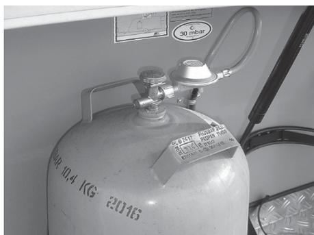
Abb. 114: Gasflasche mit Druckminderventil
