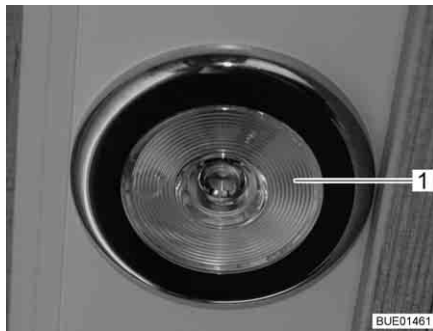
Bild 69 Infälld lampa, ljusbrytare i lampan
