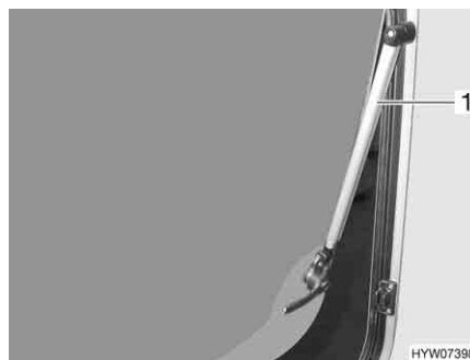
Bild 82 Överkantshängt fönster med automatik-spärr
