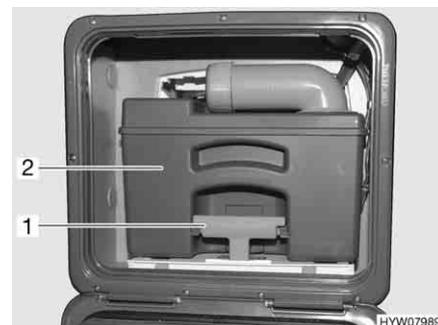
Fig. 253 Depósito de aguas fecales (ejemplo)
