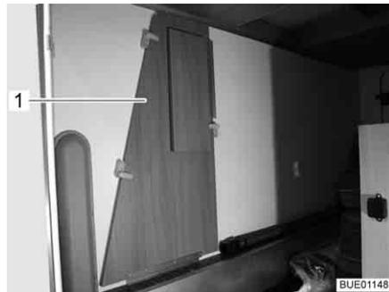
Fig. 13 Ensanchamiento de cama en el garaje trasero
