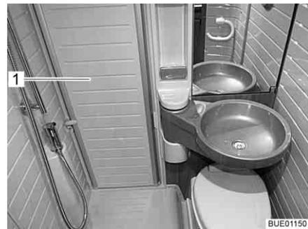
Fig. 16 Panel de separación de la ducha
