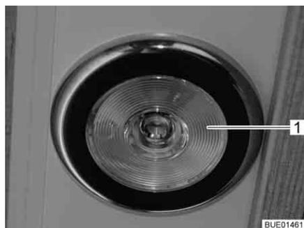
Fig. 69 Lámpara empotrada, interruptor de luz dentro de la lámpara
