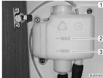
Fig. 265 Recipiente de compensación sin panel
