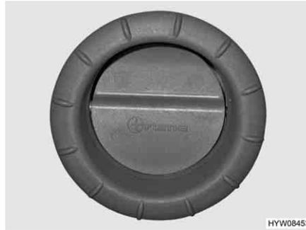
Fig. 189 Boquilla de salida de aire (calefacción de aire caliente)
