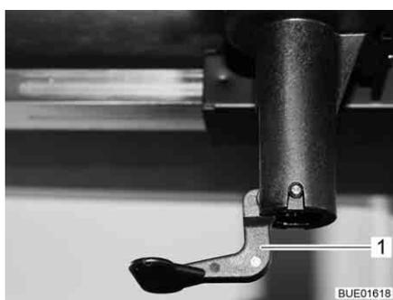
Fig. 108 Desbloqueo del tablero de la mesa
