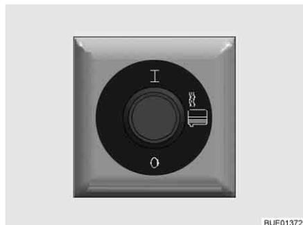
Fig. 250 Interruptor para calefacción de aguas residuales
