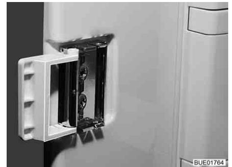
Fig. 234 Dispositivo de cierre en posición de ventilación
