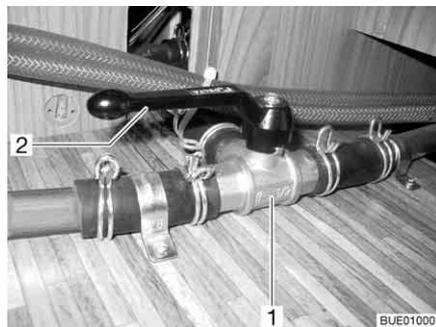
Fig. 198 Válvula de 3 vías
