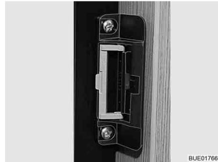
Fig. 236 Dispositivo de cierre en posición de ventilación
