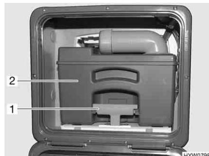
Fig. 263 Depósito de aguas fecales (ejemplo)
