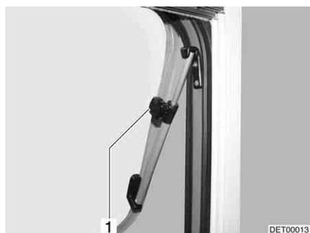
Fig. 104 Claraboya con soportes giratorios, abierta
