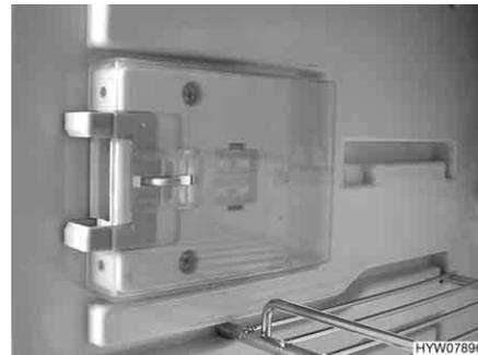
Fig. 231 Dispositivo de cierre (posición de ventilación)
