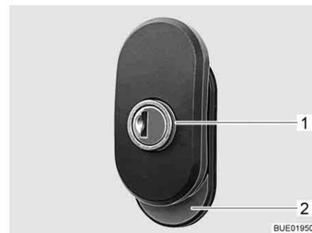
Fig. 54 Cerradura de la trampa abierta
