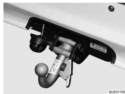
Fig. 7 Acoplamiento de remolque, desmontable
