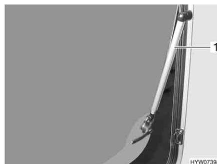
Fig. 82 Ventana abatible con soporte automático
