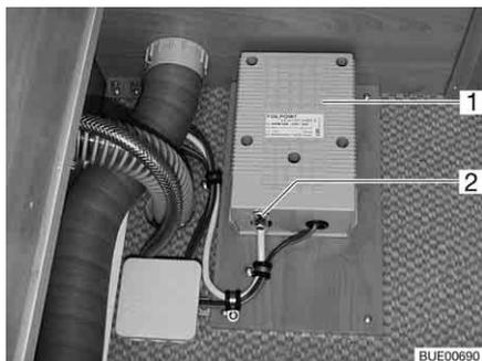
Fig. 205 Transformador para calentamiento eléctrico del piso
