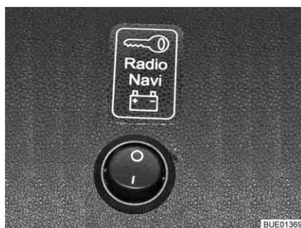
Fig. 165 Conmutador selector para el comportamiento de funcionamiento
