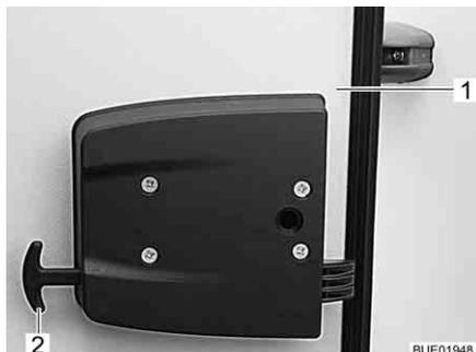
Fig. 50 Desbloqueo de emergencia de la trampilla del garaje
