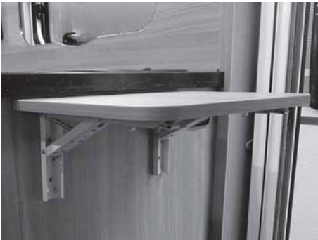
Afb. 210: Klapconsole voor het verlengen van het keukenwerkblad
