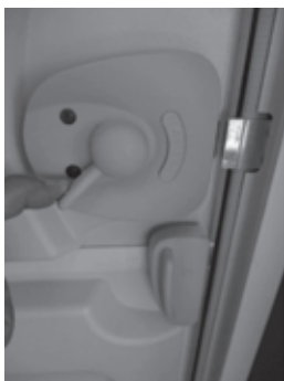
Fig. 18: Palanca abajo, abrir la puerta
