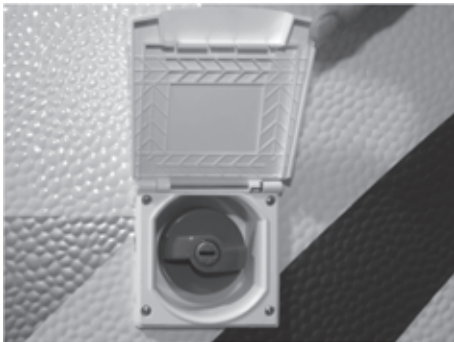
Fig. 80: Tubo de carga de agua limpia
