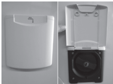
Fig. 89: Tubo de carga de agua limpia
