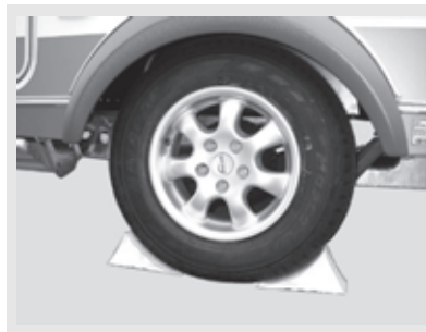
Fig. 148: Asegurar el vehículo
