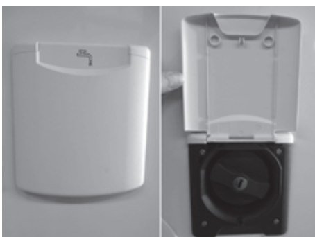
Fig. 23: Tubo de carga de agua limpia
