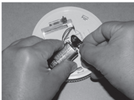
Fig. 101: Reemplazar la pila monobloc
