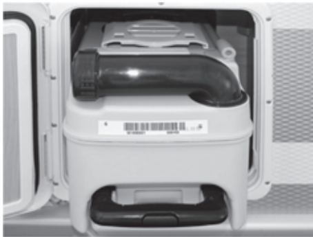
Fig. 43: Depósito para materias fecales
