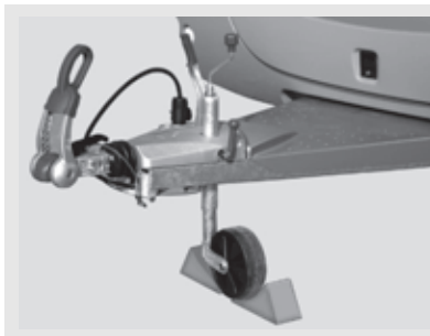
Fig. 147: Asegurar la rueda de apoyo
