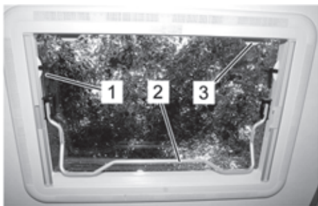
Fig. 111: Manejar el techo para elevar y girar Heki 2
