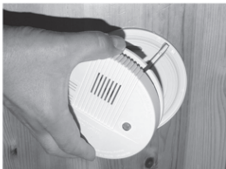
Fig. 100: Retirar la carcasa
