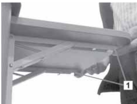
Fig. 120: Allentare il bloccaggio
