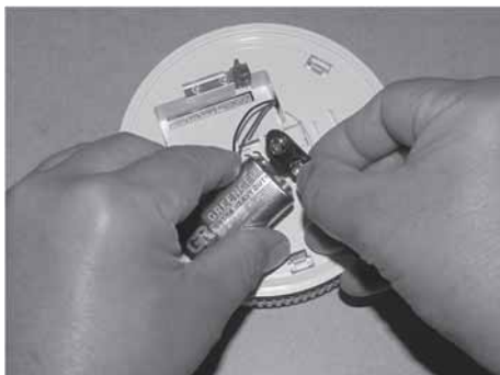
Fig. 94: Sostituire la batteria rettangolare
