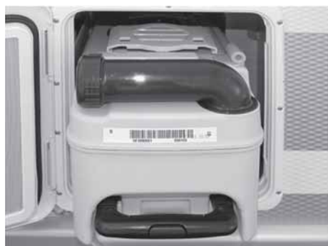
Fig. 40: Serbatoio acque nere
