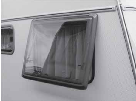
Fig. 22: Finestra orientabile con telaio
