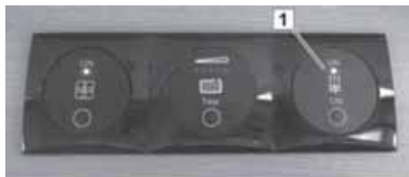
Afb. 75: Aan/uit-schakelaar van de vloerverwarming
