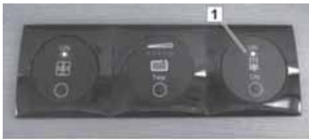
Afb. 111: Aan/uit-schakelaar van de vloerverwarming
