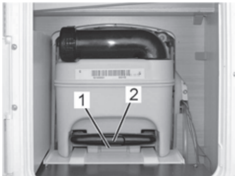
Abb. 133: Fäkalientank im Entsorgungsschacht
