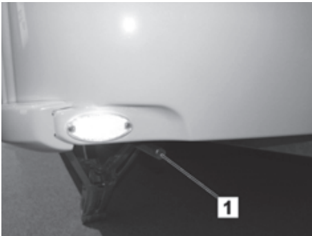
Abb. 10: Sechskant (1) für Steckschlüssel
