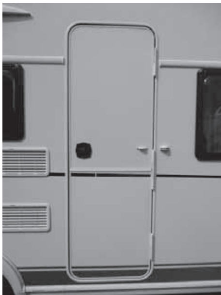
Abb. 13: Eingangstür ohne Fenster (Beispiel)
