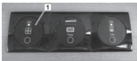
Abb. 87: Ein-/Aus-Schalter der Warmwasserbereitung
