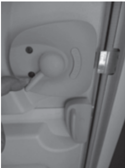
Abb. 18: Hebel unten, Tür öffnen
