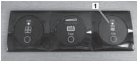
Abb. 119: Ein-/Aus-Schalter der Fußbodentemperierung
