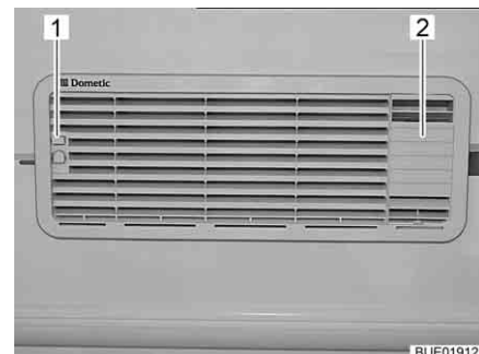
Afb. 174 Koelkast-ventilatioerooster (met inzet voor uitlaatgasafvoer)
