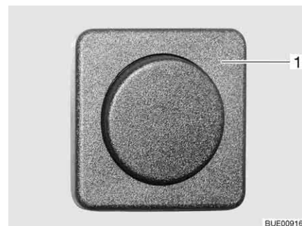
Afb. 48 Binnenverlichting, lichtschakelaar gescheiden van de lamp
