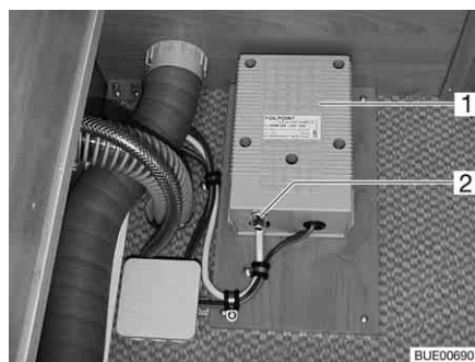
Afb. 154 Transformator voor de elektrische vloerverwarming
