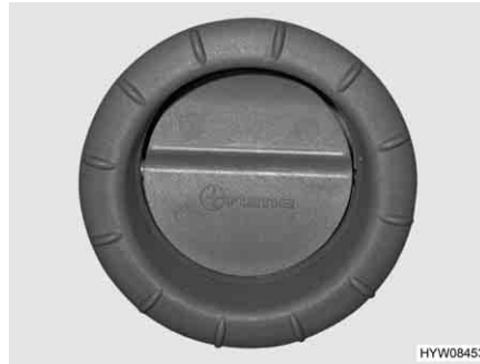
Afb. 138 Luchtuitstroomopening van de heteluchtverwarming
